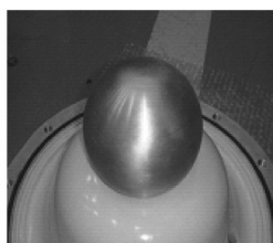
图1 悬浮放电模型 Fig. 1 Floating discharge model
